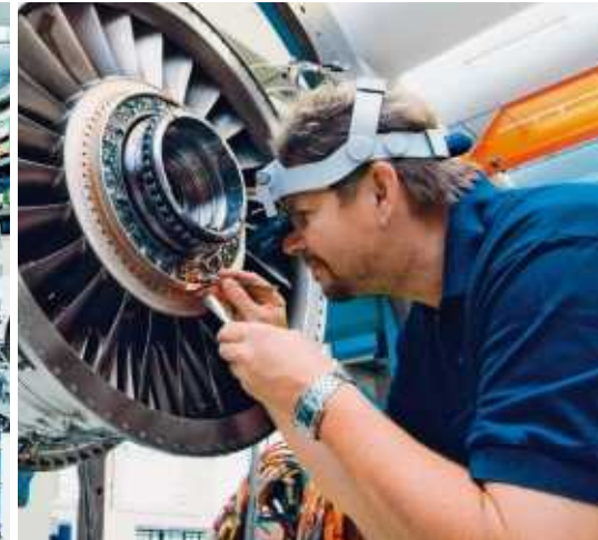
Moderne Blisks werden aus einem Stück gefräst.
